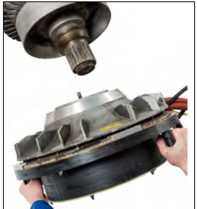
3. Kraftloses Abziehen des Lüfterrades
