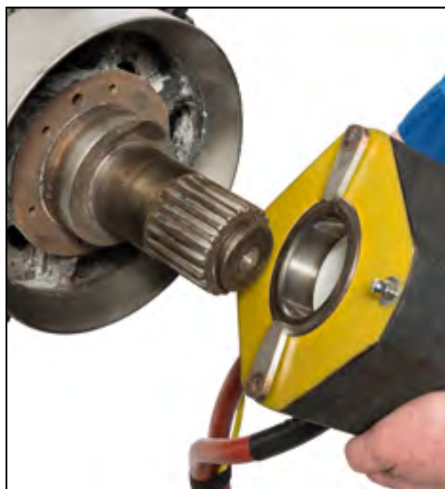
3. Kraftloses Abziehen der Lagerringe innerhalb von Sekunden
