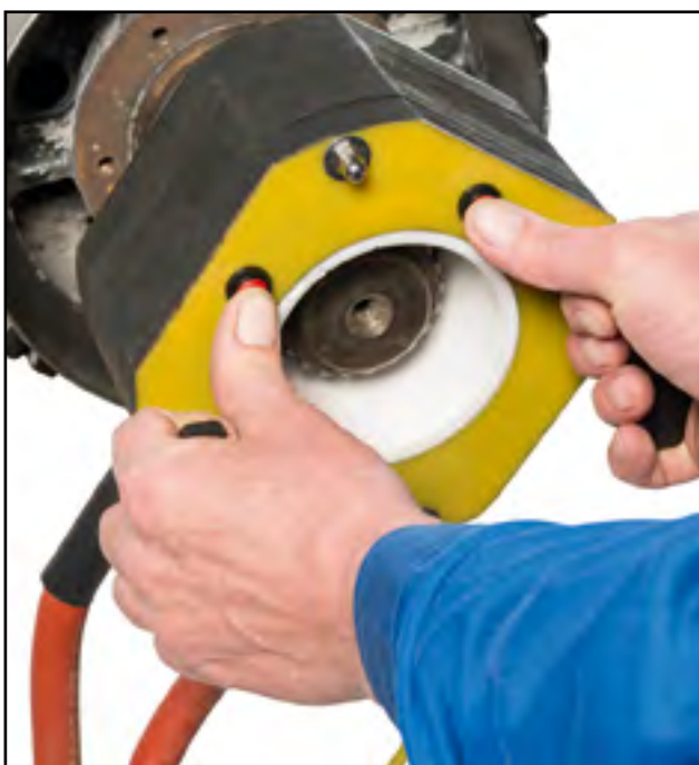
2. Induktives Erwärmen der Lagerringe durch Tastendruck
