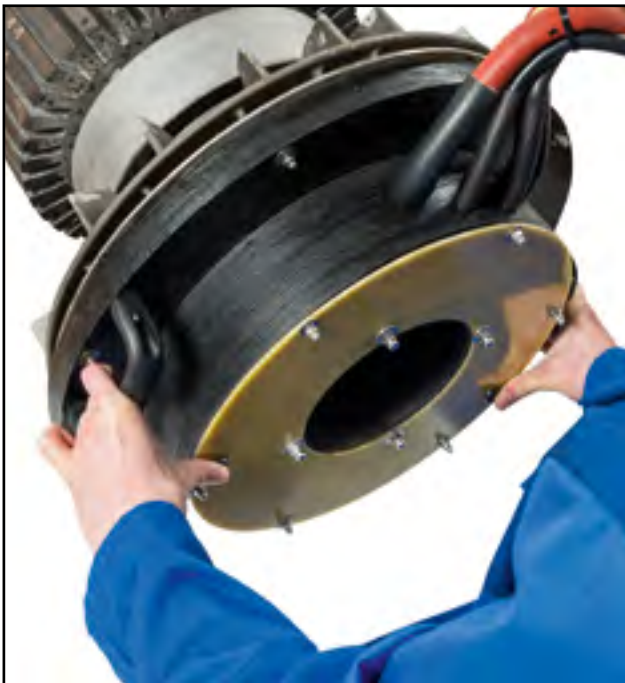
2. Induktives Erwärmen des Lüfterrades durch Tastendruck
