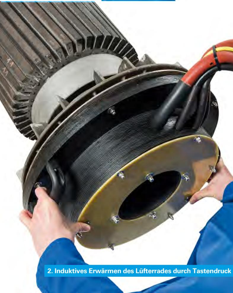
2. Induktives Erwärmen des Lüfterrades durch Tastendruck
