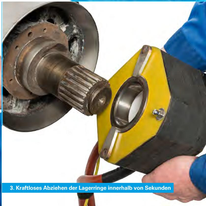
3. Kraftloses Abziehen der Lagerringe innerhalb von Sekunden
