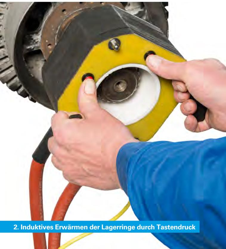
2. Induktives Erwärmen der Lagerringe durch Tastendruck
